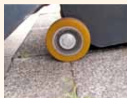
Der Saugrüssel wird beim Überfahren von Hindernissen durch Tastrollen vor Beschädigung geschützt.
