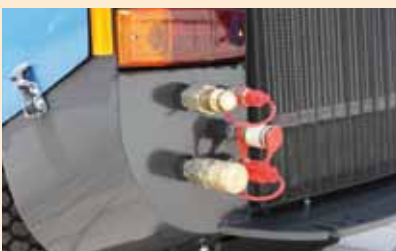
Die Heckhydraulikanschlüsse sind gut erreichbar angebracht.
