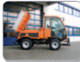
Transportgenie mit hydraulisch kippbarer Ladepritsche
