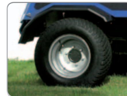
Universal-Rasenbereifung: 1600 mm Außenbreite
