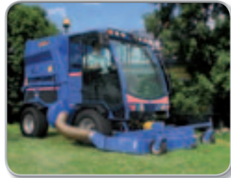
Vollhydraulische Grasaufnahme mit 1600-Liter-Sammelbehälter
