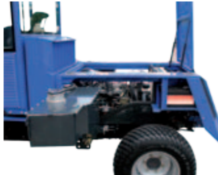
Die beiden Tanks für Kraftstoff und Öl werden zum leichteren Wartungszugang einfach nach außen geschwenkt.
