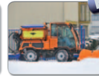
Das Multi-Konzept ermöglicht den Anbau eines Feuchtsalzstreuers von Küpper Weissner und Keilschild
