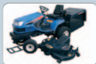
Lenkung einschlagen und Mähwerk am Griff anfassen und herausziehen.
