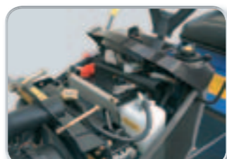
Die geschützte Batterie befindet sich hinter dem Armaturenbrett.
