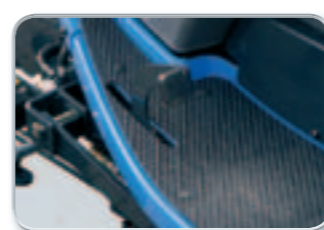
Mechanische Differentialsperre für den Einsatz in schwierigem Gelände oder im Winterdienst.
