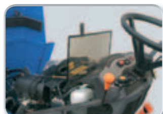
Das Kühlersieb ist werkzeuglos von oben zugänglich.
