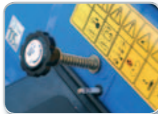
Stufenlose Schnitthöheneinstellung vom Sitz aus, mit Anzeige der vorgewählten Schnitthöhe.
