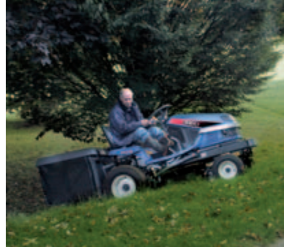
In Hanglagen oder auf rutschigem Untergrund hilft die serienmäßige Differentialsperre.
