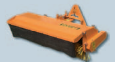
Frontkehrmaschine: 100/125 cm Arbeitsbreite, wahlweise mit Behälter
