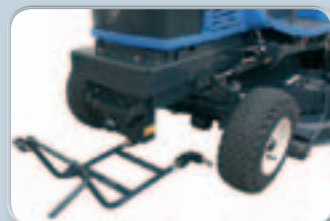
Zuggestänge entriegeln und mit Schnellarretierungsbolzen vom Mähwerk trennen. Hydraulik anheben.
