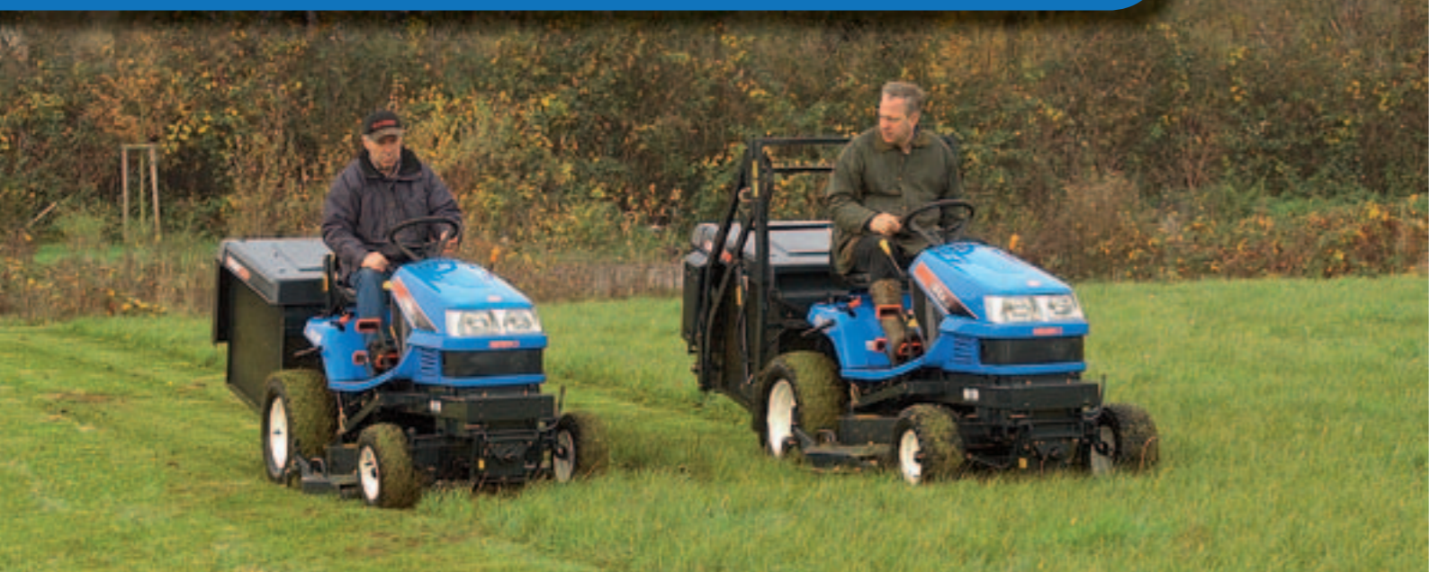
In Hanglagen oder auf rutschigem Untergrund hilft die serienmäßige Differentialsperre.
