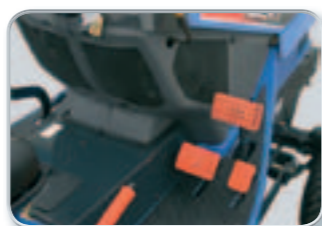
Stufenlose Bedienung des Fahrtriebs durch 2-Pedal-Steuerung.
