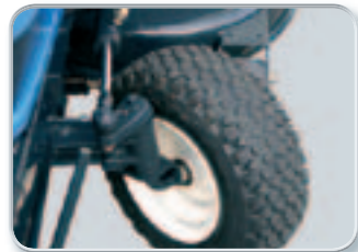
Hohe Wendigkeit durch großen Lenkeinschlagswinkel.
