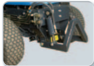
Optional: Fronthubwerk mit Anschlüssen für hydraulische Seitenverstellung.
