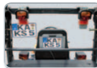
Optional: Beleuchtungsanlage gemäß SiVZO.
