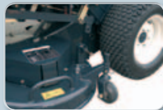
Laufrollen um 90° drehen und Schnellarretierungsbolzen werkzeuglos lösen.
