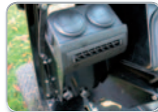
Optional: Leistungsstarke Warmwasserheizung bei Kabinenausführung.
