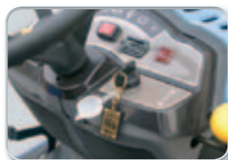
Armaturenbrett mit Betriebsstundenzähler und allen wichtigen Funktionsanzeigen.
