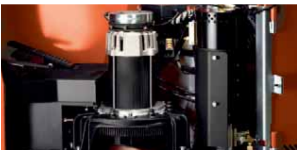
Durch den Wegfall von Kohlebürsten und Schützen im AC-Fahrmotor verringert sich die Ausfallzeit bei Wartungsarbeiten
