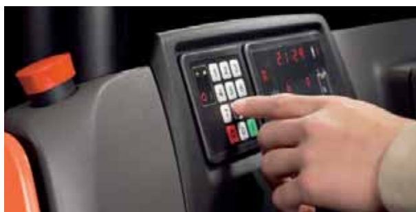
Die BT Reflex N-Serie verfügt standardmäßig über eine PIN-Code-Aktivierung, um sicherzustellen, dass die Stapler ausschließlich von autorisierten Fahrern genutzt werden.
