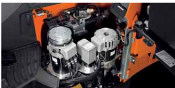
Versiegelte Elektronikseinheiten, Motoren ohne Kohlebürsten und leckagefreie Verbindungen sorgen für die hohe Zuverlässigkeit der BT Reflex R-Serie
