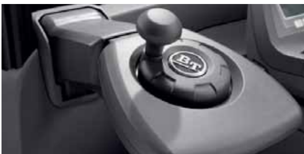
Die elektronisch progressive 360°-Lenkung macht den BT Reflex besonders wendig
