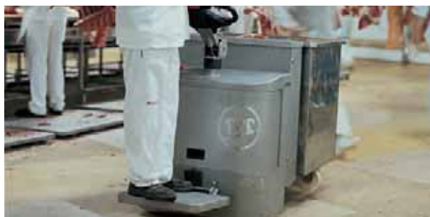
Das Modell LPE200I aus rostfreiem Stahl für lange Haltbarkeit in korrosionsgefährdeten Umgebungen
