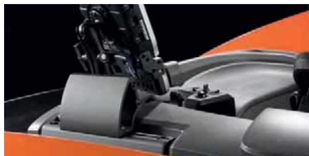
Über die E-Bar-Universalschiene lassen sich Zusatzgeräte wie PCs, Terminals, Barcode-Leser leicht anbauen
