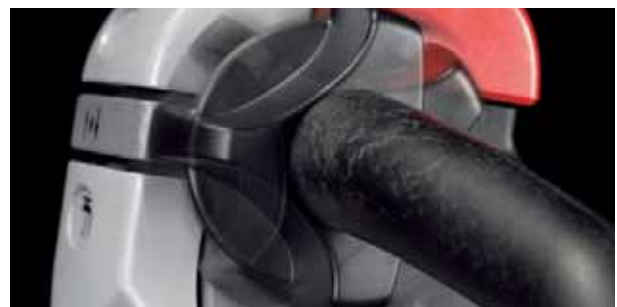
Die Click-2-Creep-Funktion ermöglicht das Manövrieren des Fahrzeugs mit senkrecht stehender Deichsel
