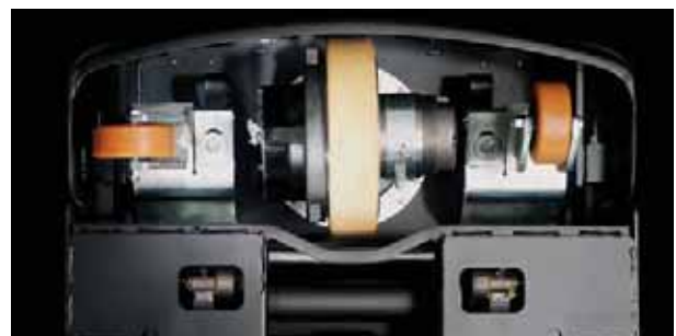
Das 5-Punkt-Chassis des LWE130 gewährleistet optimale Stabilität und Kontrolle – die Lenkräder drehen sich innerhalb des Fahrzeugprofils
